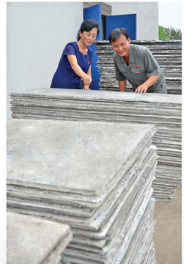
Опалубки из легкой магнезии.
